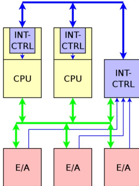
Interrupt-Controller sind selbständige, konfigurierbare Einheiten...
